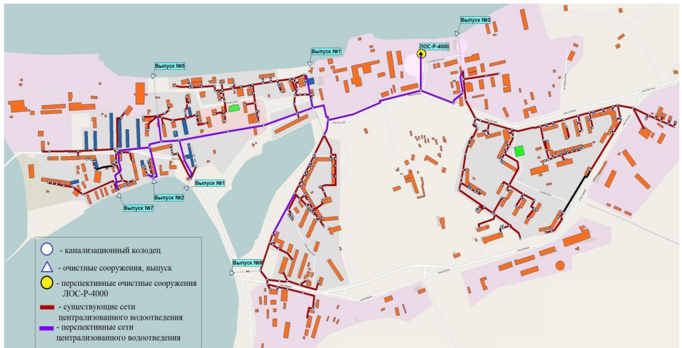
Рисунок 1.4.4.1 Схема перспективных сетей бытовой канализации и очистных сооружений г. Певек.»
